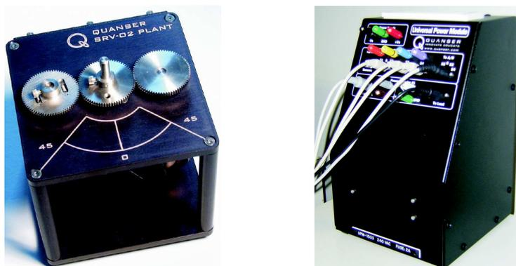
Figura 1: Motor e amplificador de potência a utilizar no laboratório.
