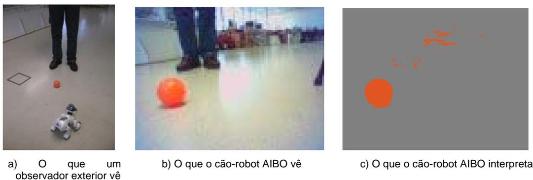
Figura 12 - Detecção de bola por cão-robot AIBO da Sony
